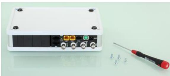
Drehen Sie den *ProfiLux4* auf den Kopf und lösen Sie vorsichtig die 4 Inbus-Schrauben in den 4 Ecken der Gehäusebodenplatte. Ziehen Sie Schrauben heraus und drehen Sie das Gehäuse zusammen mit dem Boden wieder herum.
