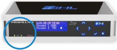
Auf der Gehäusefront von *ProfiLux4* befinden sich neben der roten Alarm LED noch zwei LEDs, die über die WiFi Verbindung und Kommunikation Anschluss geben.
