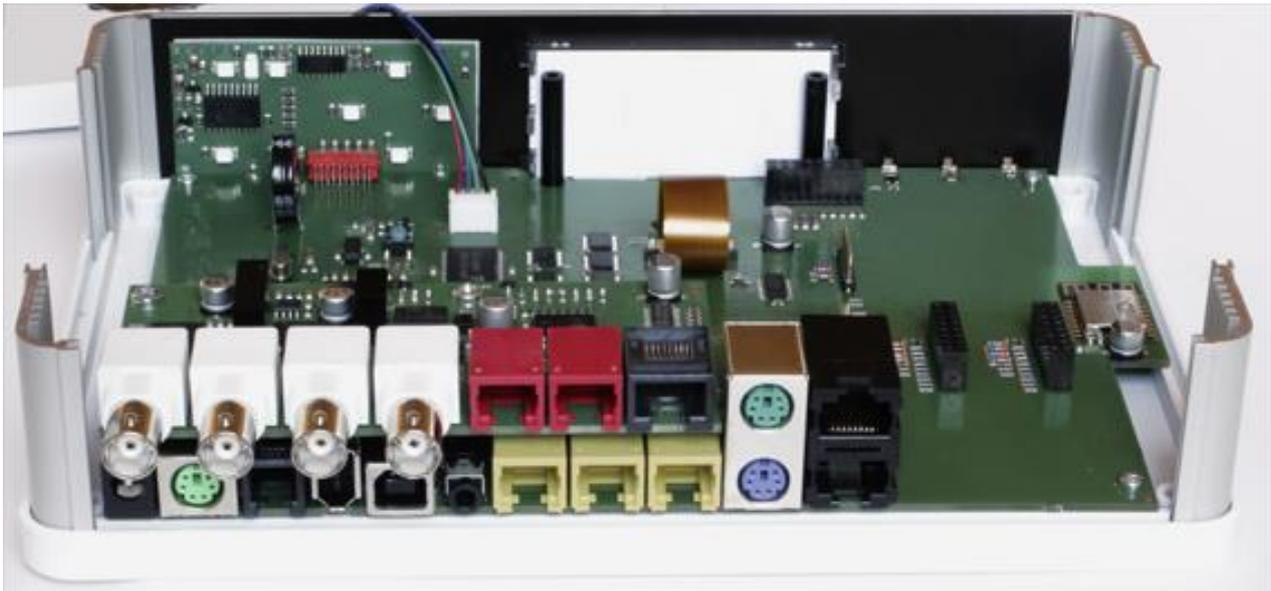
Rechts sind die freien Steckplätze zum Einstecken der Module zu sehen, links daneben befinden sich die werksseitig bereits eingebauten Anschlüsse.
